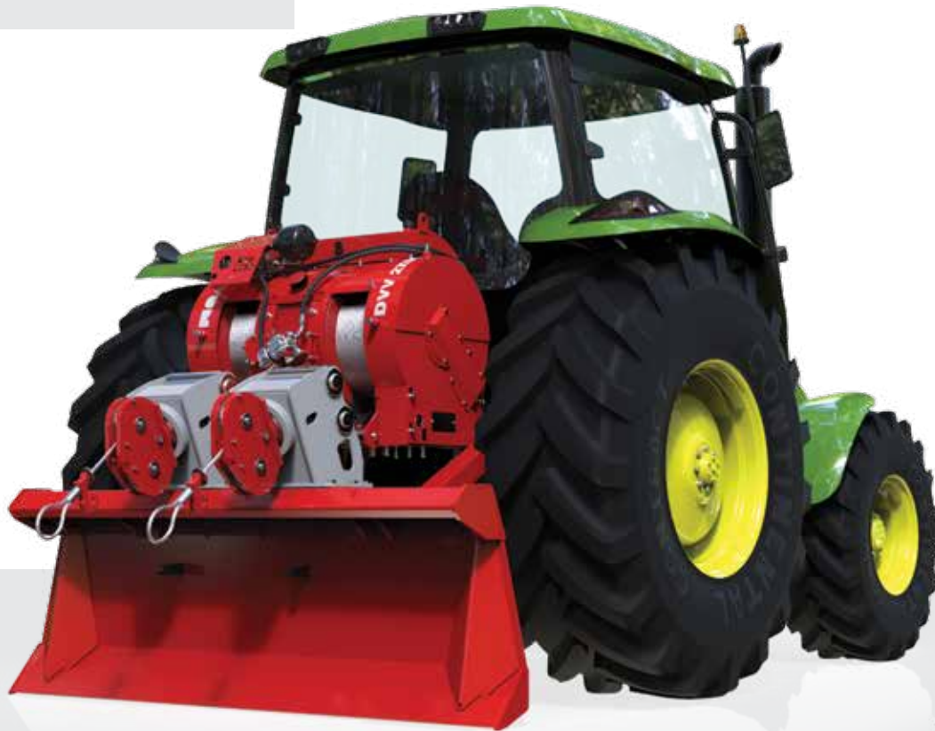
Masywne bębny o dużej pojemności i łatwym montażu liny stalowej
